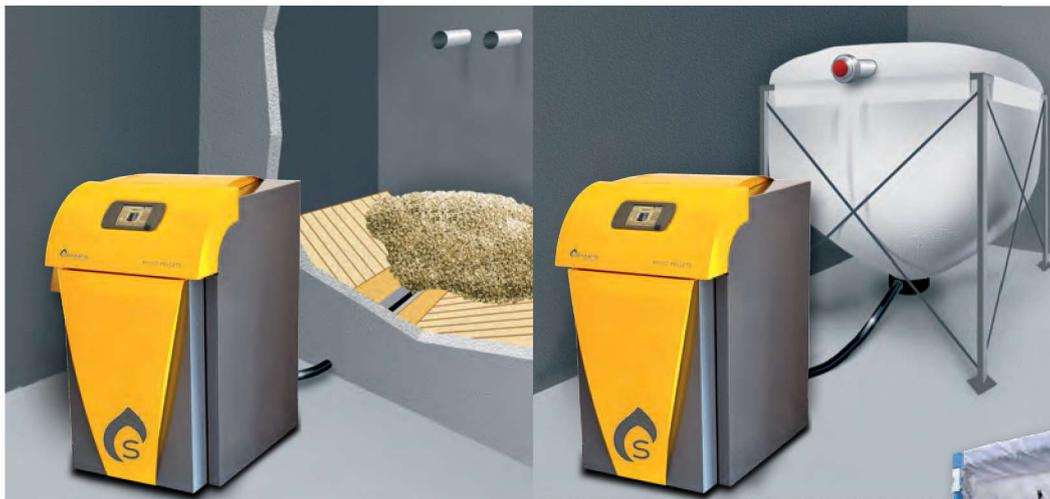
Das Gewebesilo fasst 2 - 6 t und ist für Räume mit normalen kellerfeuchten Wänden geeignet. Es darf aber nicht an feuchten, nassen Wänden anliegen. Bei Aufstellung im Freien muss der Gewebetank vor Regen und UV-Licht geschützt werden. Die Tragfähigkeit muss für eine Punktlast von mindestens 1500 kg geeignet sein.
